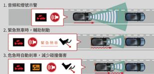
若偵測到您的車輛接近前方車輛時，儀表板上的指示燈會即時亮起，並同步響起警報聲，提醒您減速；當與前車的行車距離過近時，系統會即時提供自動煞車輔助，避免發生碰撞。
